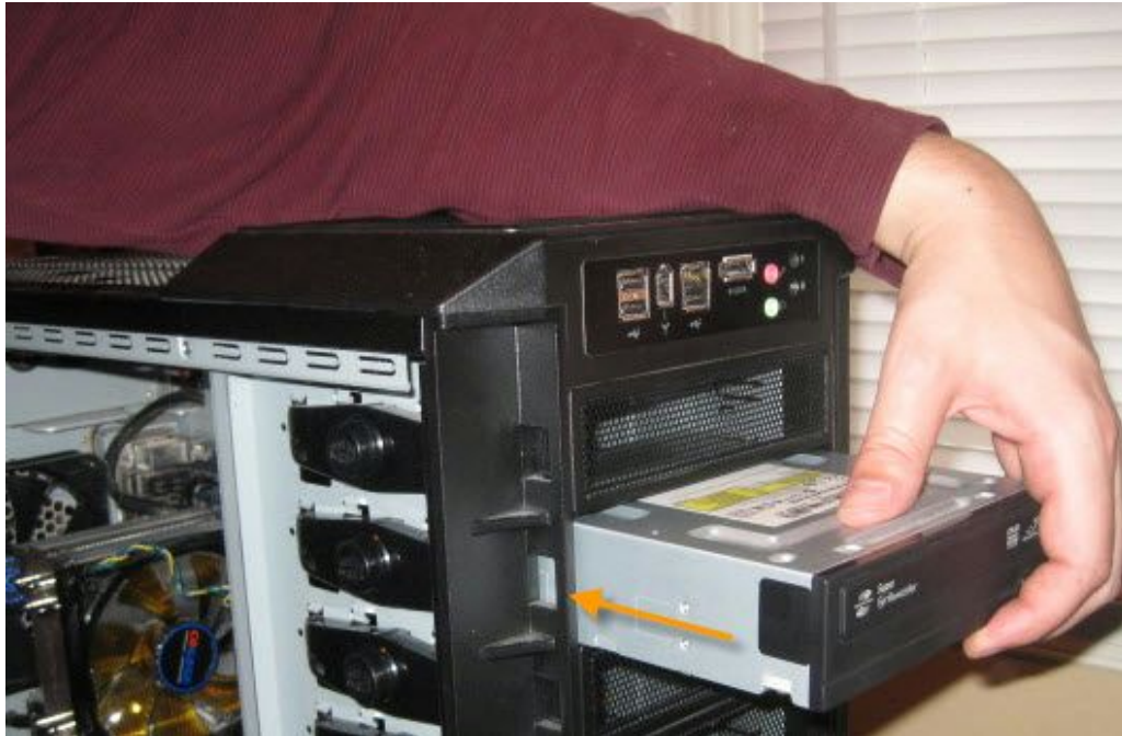
Fig. 9a: Installing Media (DVD) device
